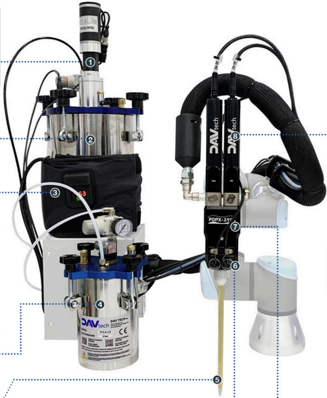
**1** Gestione di agitatori meccanici nel serbatoio e/o miscelatori dinamici sulla testa
